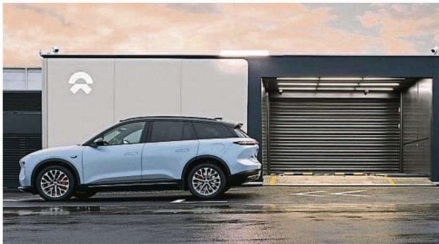
**Einfahrt zum Batteriewechsel:** Der neue Nio EL6 vor einer Power Swap Station, in welcher der leergefahrene Akku in weniger als fünf Minuten gegen einen geladenen getauscht wird. FOTO: NIO
